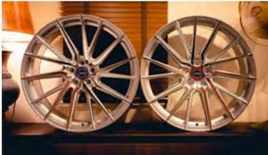
Hybrid Forged™シリーズ、HF-4Tは、鍛造シリーズのM-X4Tから派生したモデルで左右専用の方向性デザイン。スポーク部は3D加工されるなど非常に凝った形状で作られています。HF-4Tでは2色のスタンダードカラー(仕様)と8色のオプションカラー(オーダーオプション)が設定されています。
