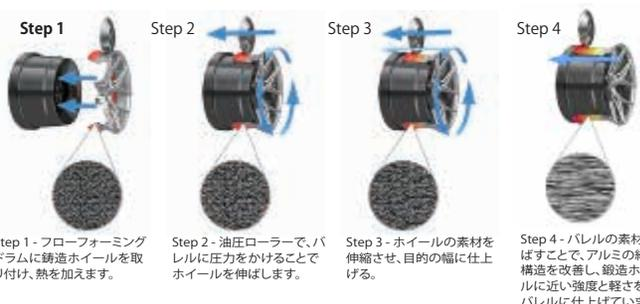
Step 1 - フローフォーミングドラムに鍛造ホイールを取り付け、熱を加えます。
